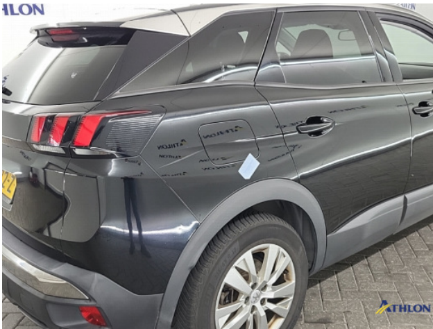
1. Zijwand - achter - rechts Deuk/deuken
