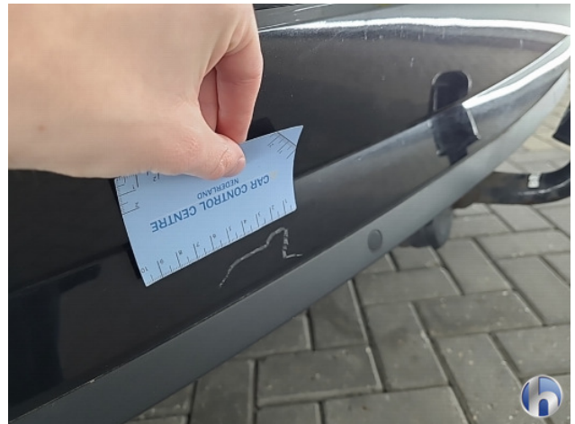
1. diverse Gebruikssporen - Aanvaardbaar
