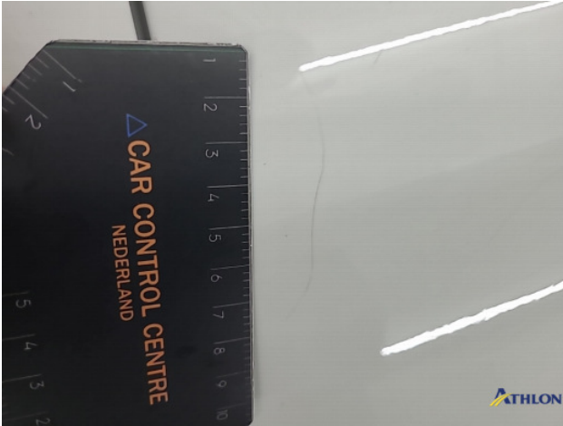
1. Zijwand - achter - Links Krassen
