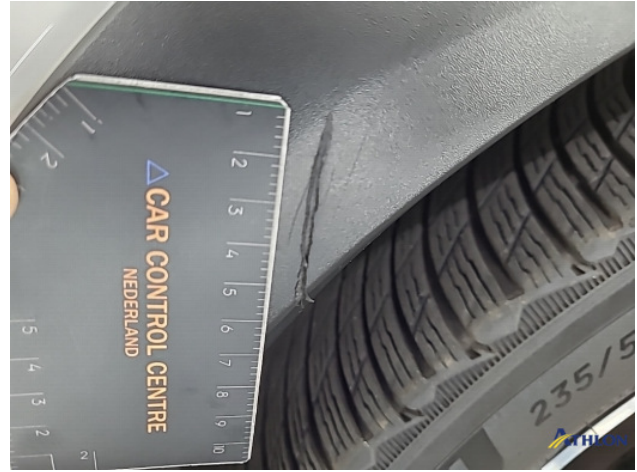
4. Wielkuip voor - rechts Beschadigd
