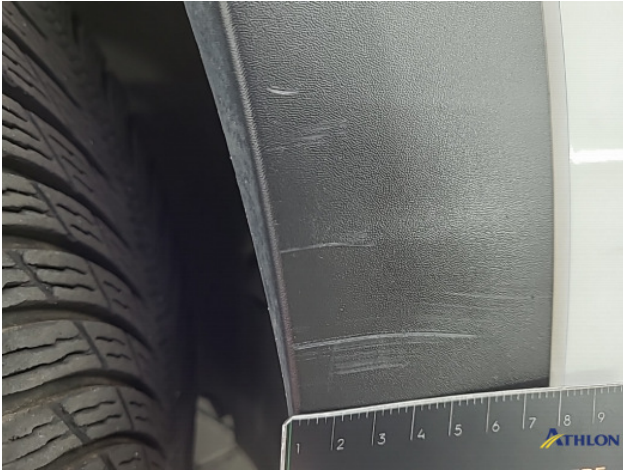
4. Wielkuip voor - rechts Beschadigd
