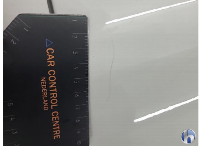
1. Zijwand - achter - Links Krassen - Aanvaardbaar
