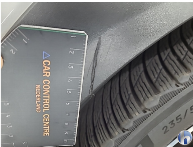
3. Wielkuip voor - rechts Beschadigd - Vernieuwen
