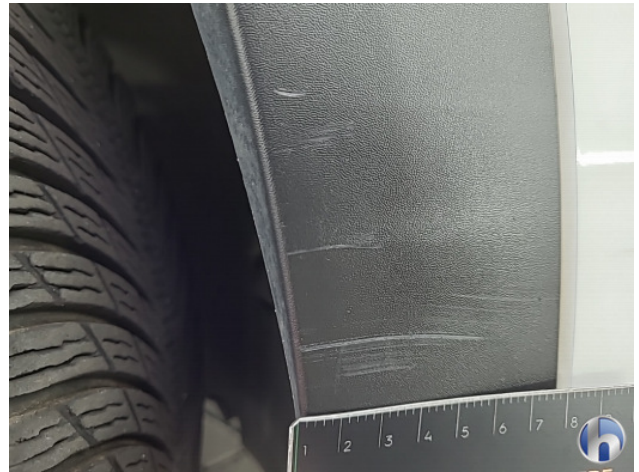
3. Wielkuip voor - rechts Beschadigd - Vernieuwen
