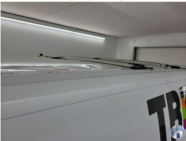
3. Dak Deuk/deuken - Herstellen
