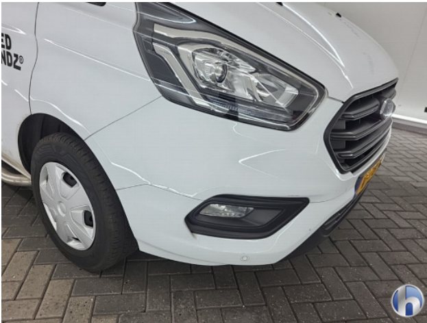
2. Voorbumper Breuk / barst / scheur - Spot Repair/Deelreparatie
