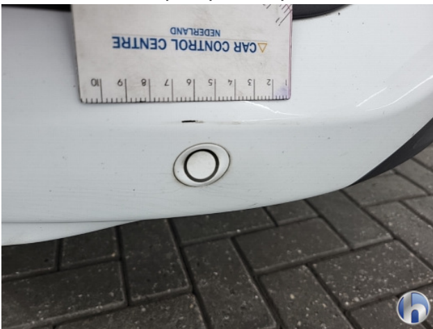
2. Voorbumper Breuk / barst / scheur - Spot Repair/Deelreparatie
