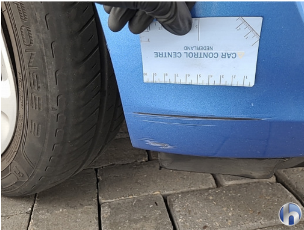
3. Voorbumper Schaafplek - Spot Repair/Deelreparatie
