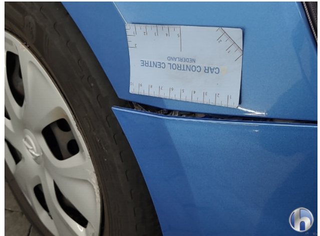
3. Voorbumper Schaafplek - Spot Repair/Deelreparatie
