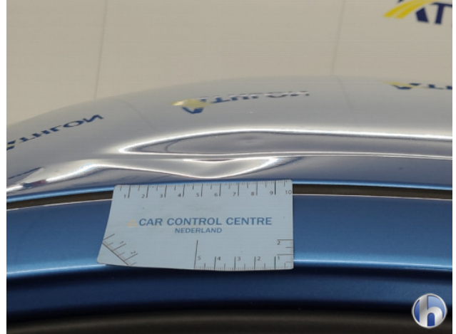
1. Dak Deuk/deuken - Herstellen
