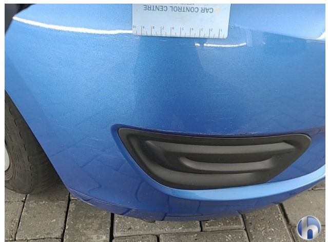
3. Voorbumper Schaafplek - Spot Repair/Deelreparatie
