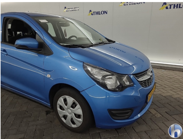
3. Voorbumper Schaafplek - Spot Repair/Deelreparatie
