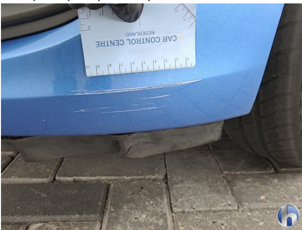
4. Voorbumper Schaafplek - Spot Repair/Deelreparatie
