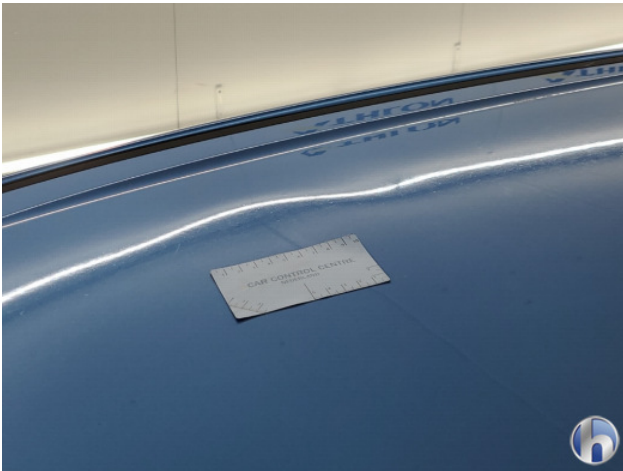
1. Dak Deuk/deuken - Herstellen
