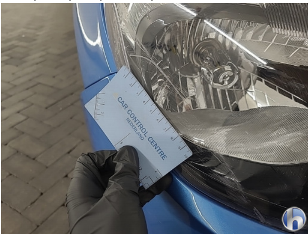
3. Voorbumper Schaafplek - Spot Repair/Deelreparatie
