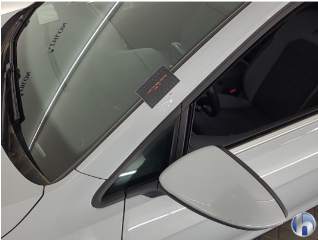
1. Dakframe - links Krassen - Aanvaardbaar
