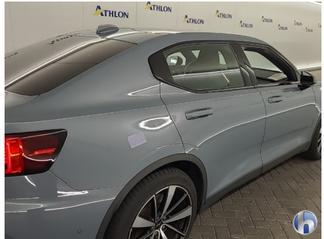
2. Zijwand - achter - rechts Krassen - Spuiten
