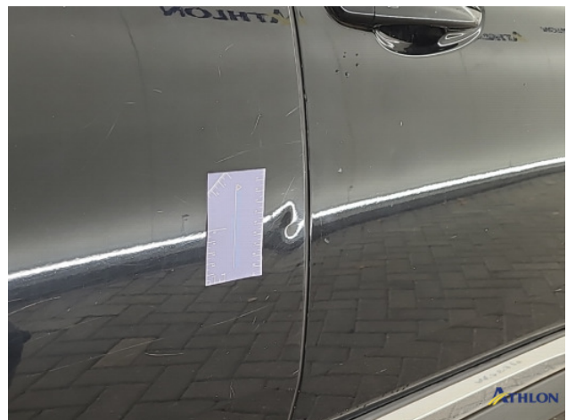
3. Portier achter - rechts Krassen
