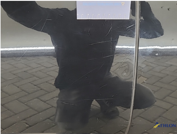
3. Portier achter - rechts Krassen
