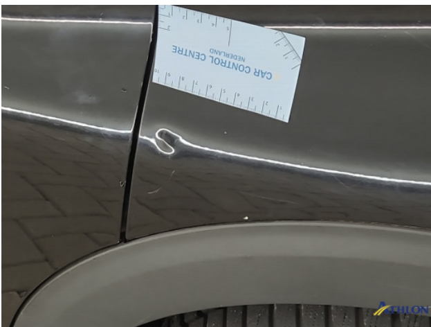
2. Zijwand - achter - Links Deuk/deuken
