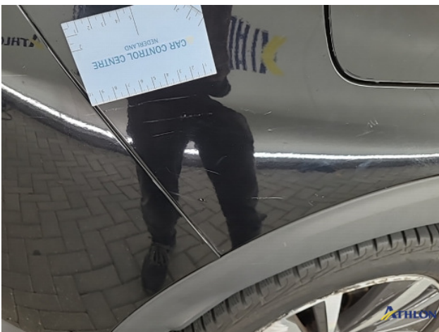
3. Portier achter - rechts Krassen
