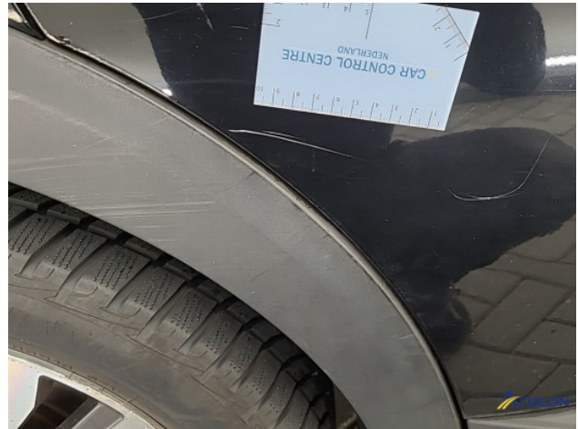
3. Portier achter - rechts Krassen
