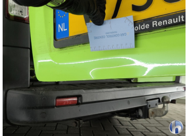
1. Achterklep Deuk/deuken - Herstellen
