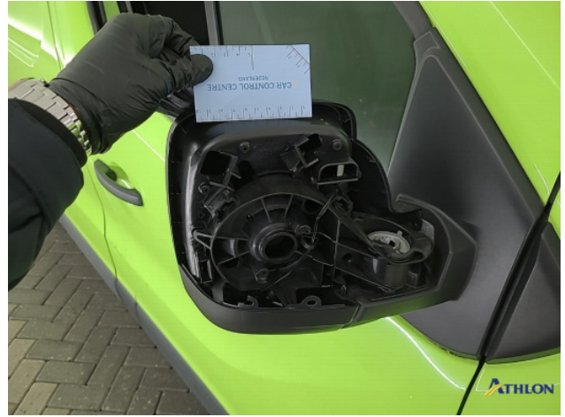
3. Spiegelbehuizing - rechts Breuk / barst / scheur
