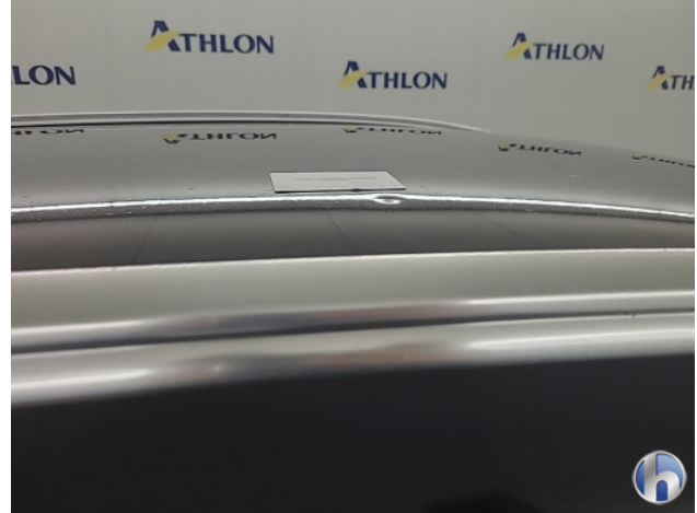
1. Dak Deuk/deuken - Aanvaardbaar
