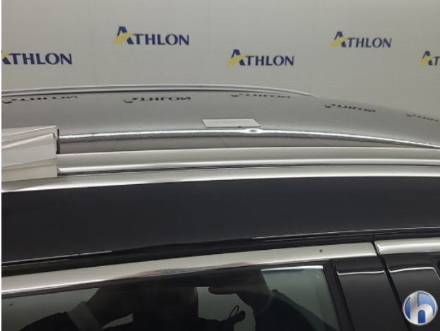
1. Dak Deuk/deuken - Aanvaardbaar
