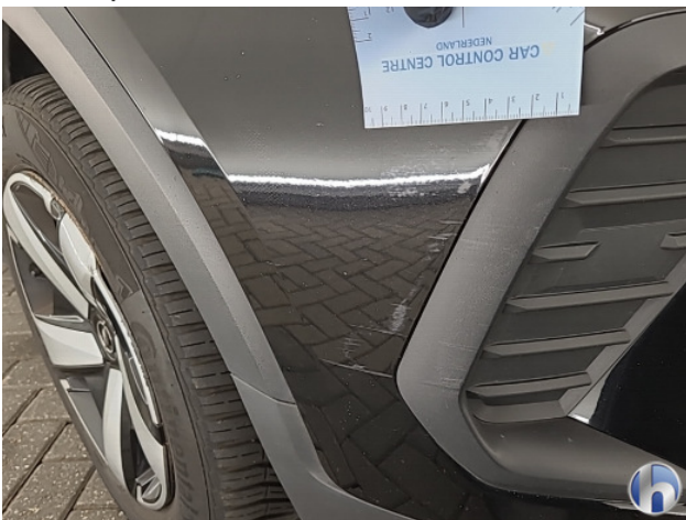
1. diverse Gebruikssporen - Aanvaardbaar
