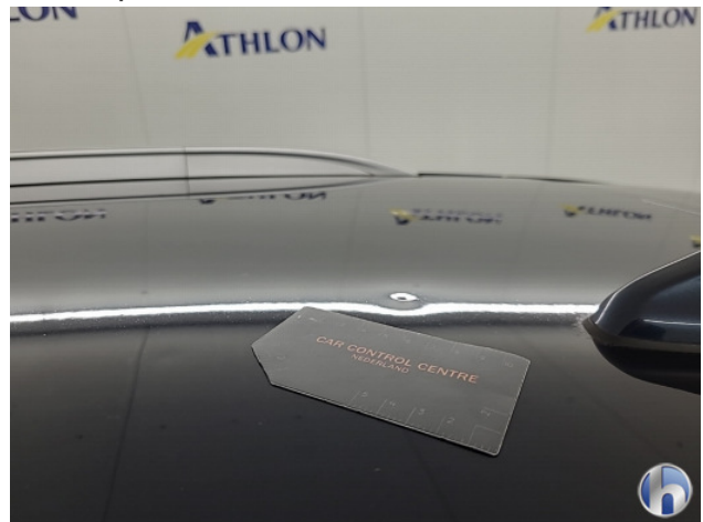
1. Dak Gebruikssporen - Aanvaardbaar
