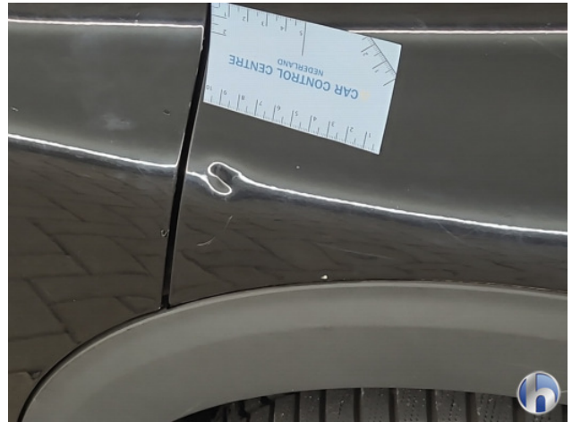
2. Zijwand - achter - Links Deuk/deuken - Herstellen zonder spuiten
