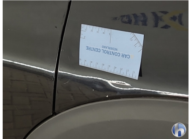
2. Zijwand - achter - Links Deuk/deuken - Herstellen zonder spuiten
