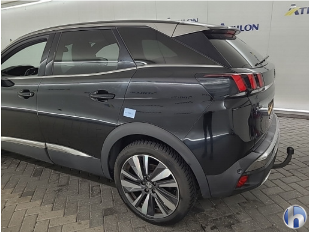
2. Zijwand - achter - Links Deuk/deuken - Herstellen zonder spuiten
