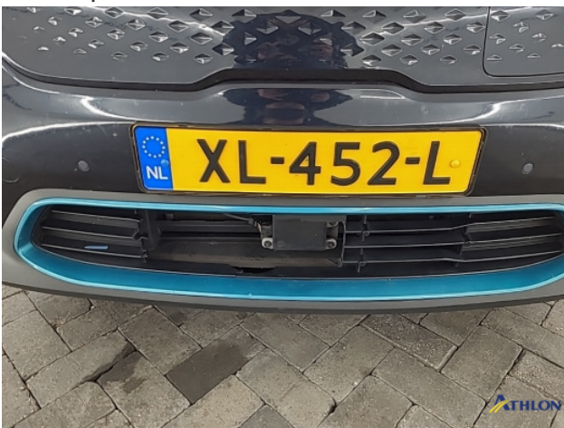
3. Voorbumper rooster Breuk / barst / scheur
