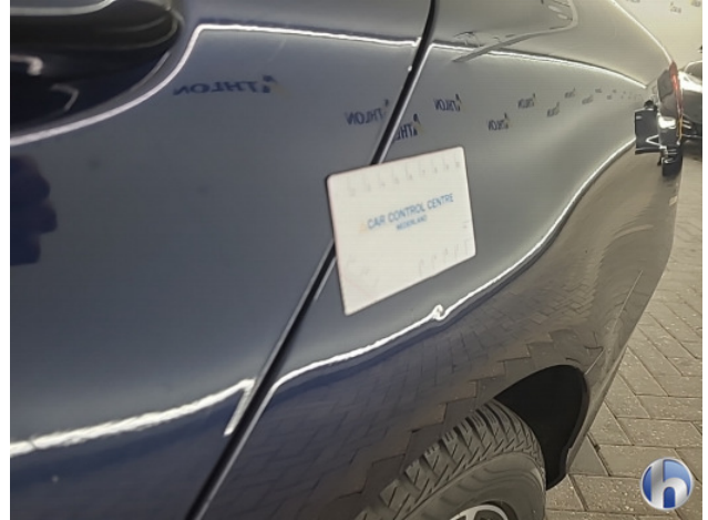
1. Zijwand - achter - Links Deuk/deuken - Aanvaardbaar
