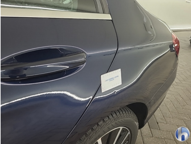
1. Zijwand - achter - Links Deuk/deuken - Aanvaardbaar
