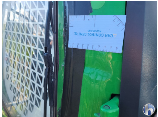
1. Achterruit Breuk / barst / scheur - Aanvaardbaar
