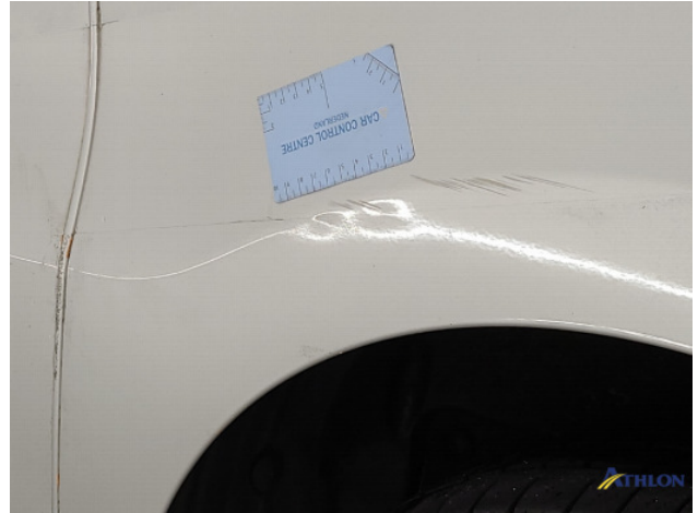
2. Zijwand - achter - Links Deuk/deuken
