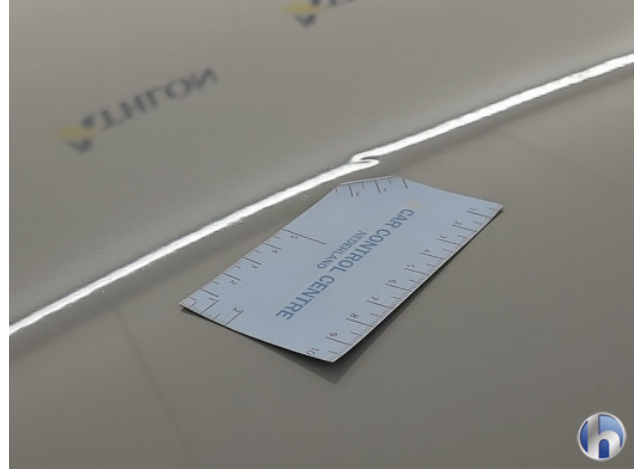
1. Diverse Gebruikssporen - Aanvaardbaar
