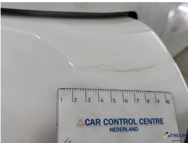
1. Zijwand - achter - Links Deuk/deuken
