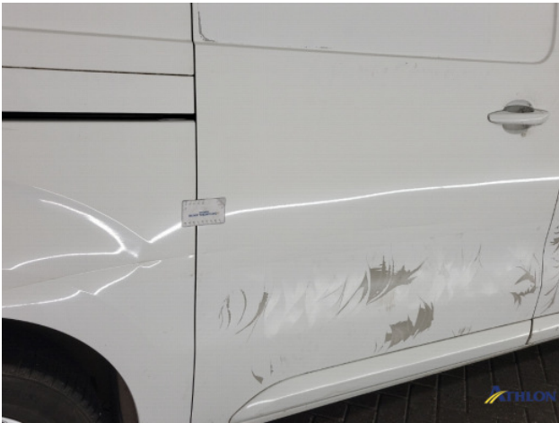
3. Zijwand - achter - rechts Deuk/deuken
