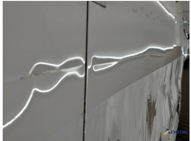
3. Zijwand - achter - rechts Deuk/deuken
