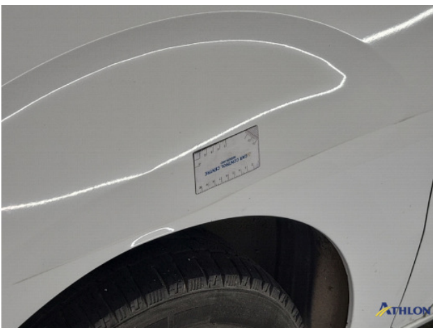
3. Zijwand - achter - rechts Deuk/deuken
