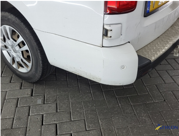
1. Zijwand - achter - Links Deuk/deuken
