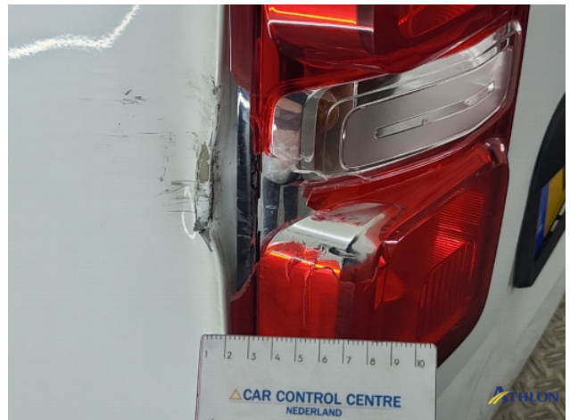
1. Zijwand - achter - Links Deuk/deuken
