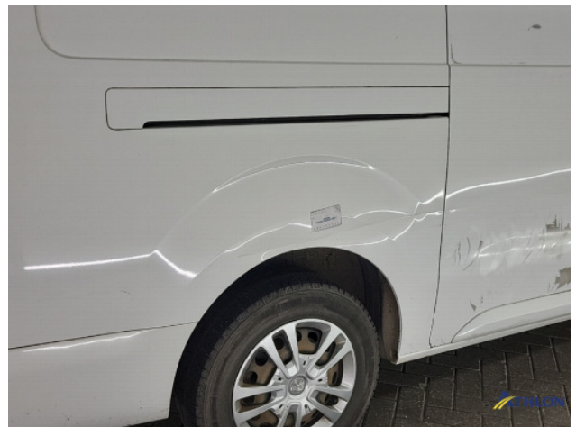
3. Zijwand - achter - rechts Deuk/deuken
