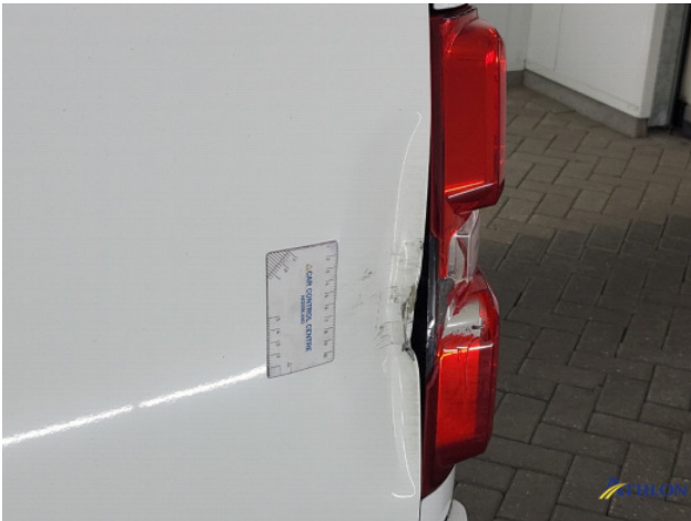
1. Zijwand - achter - Links Deuk/deuken
