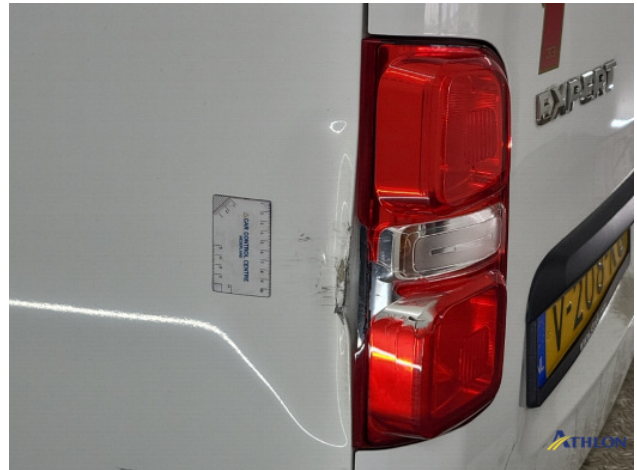
1. Zijwand - achter - Links Deuk/deuken
