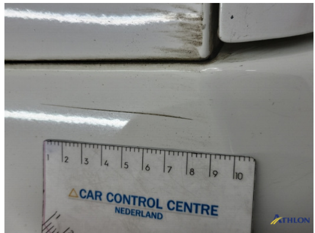
1. Zijwand - achter - Links Deuk/deuken
