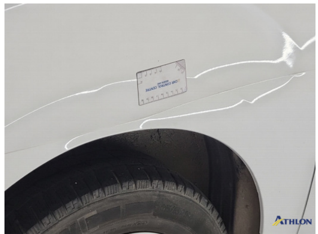
3. Zijwand - achter - rechts Deuk/deuken
