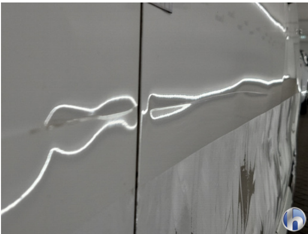
3. Zijwand - achter - rechts Deuk/deuken - Herstellen
