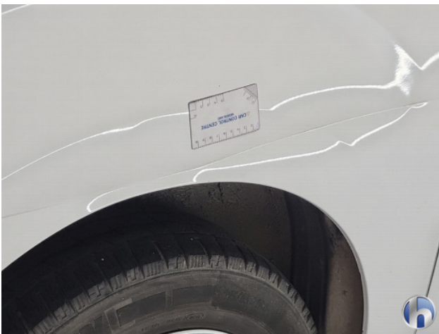
3. Zijwand - achter - rechts Deuk/deuken - Herstellen
