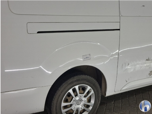
3. Zijwand - achter - rechts Deuk/deuken - Herstellen
