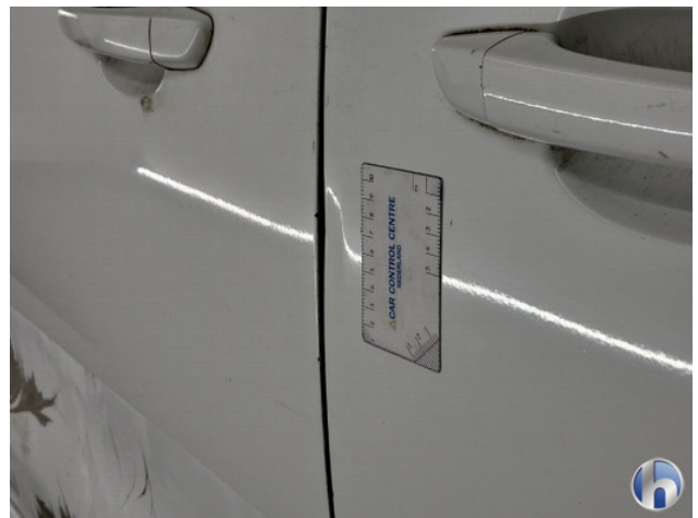
5. Portier voor - rechts Deuk/deuken - Herstellen zonder spuiten
