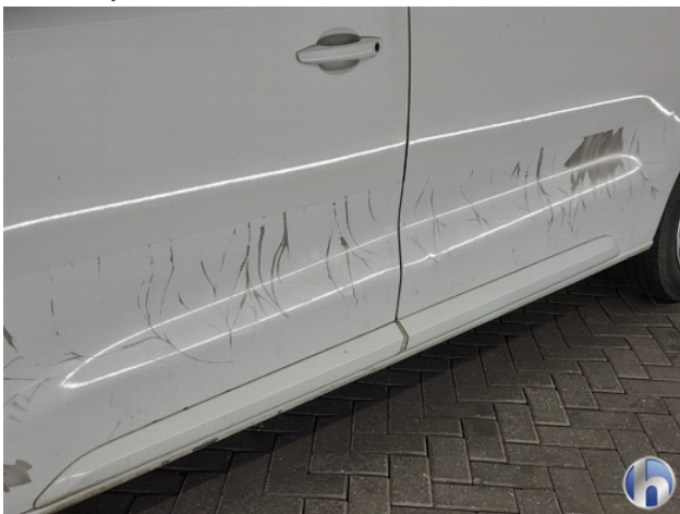
2. ontstickerresten Gebruikssporen - Aanvaardbaar
