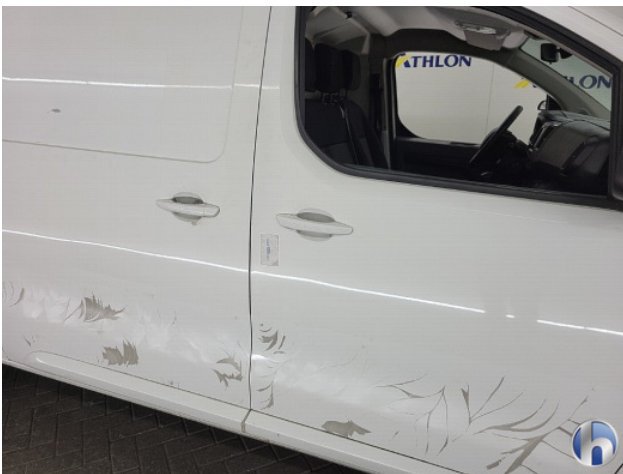
5. Portier voor - rechts Deuk/deuken - Herstellen zonder spuiten
