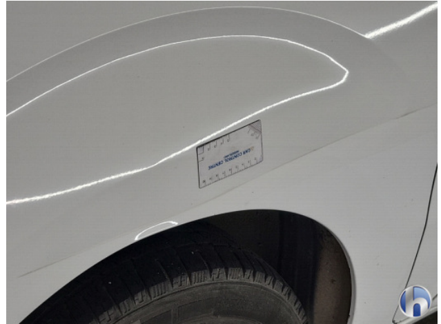
3. Zijwand - achter - rechts Deuk/deuken - Herstellen
