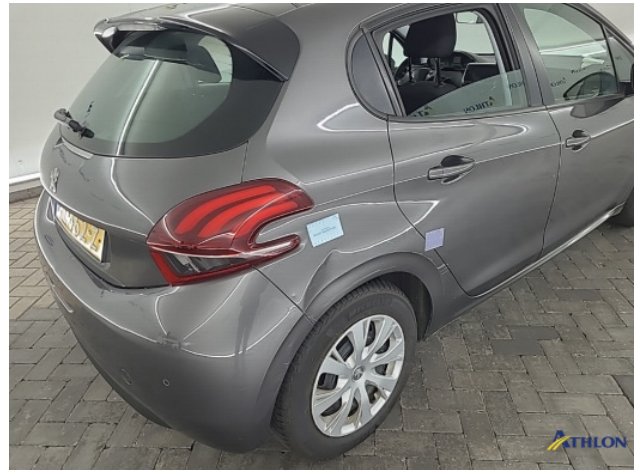
1. Zijwand - achter - rechts Deuk/deuken
