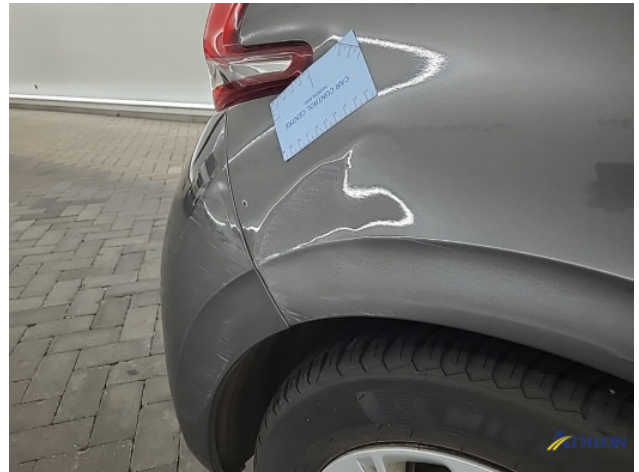
1. Zijwand - achter - rechts Deuk/deuken
