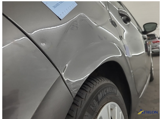
1. Zijwand - achter - rechts Deuk/deuken
