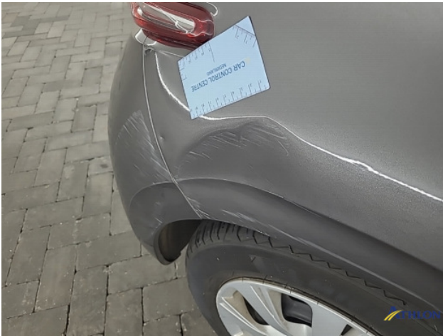
1. Zijwand - achter - rechts Deuk/deuken
