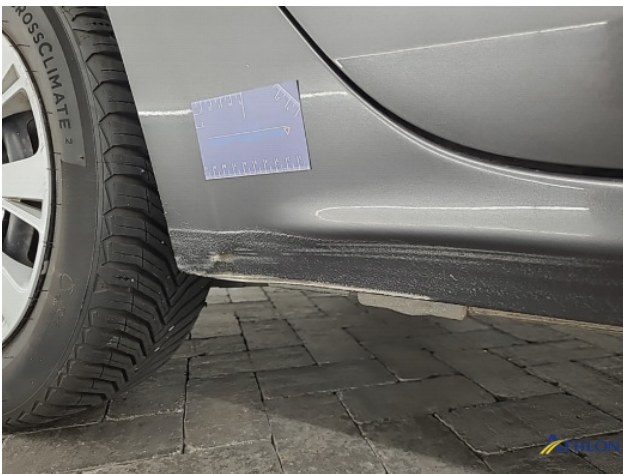
1. Zijwand - achter - rechts Deuk/deuken
