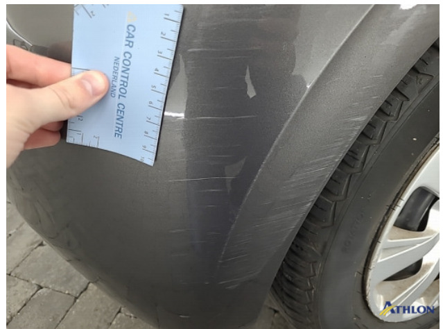
1. Zijwand - achter - rechts Deuk/deuken
