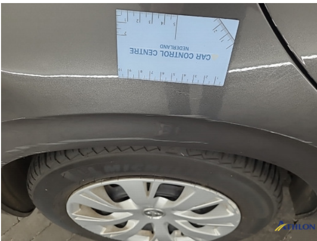
1. Zijwand - achter - rechts Deuk/deuken
