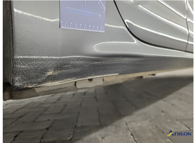
1. Zijwand - achter - rechts Deuk/deuken
