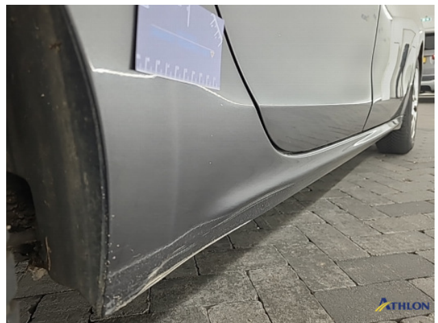
1. Zijwand - achter - rechts Deuk/deuken
