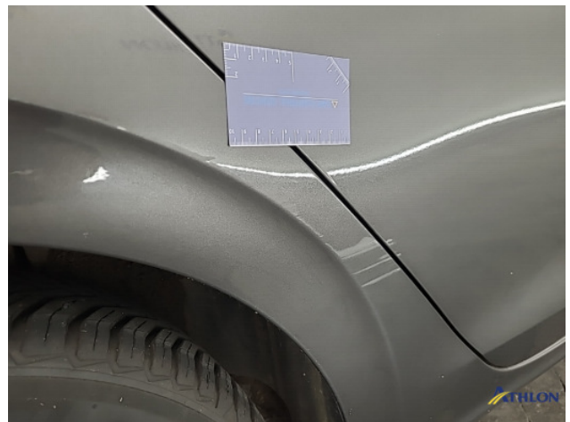
1. Zijwand - achter - rechts Deuk/deuken
