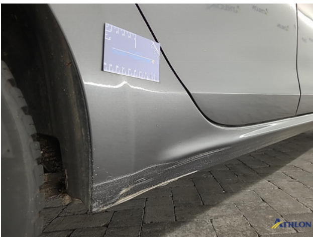
1. Zijwand - achter - rechts Deuk/deuken
