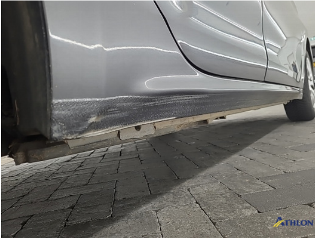
1. Zijwand - achter - rechts Deuk/deuken
