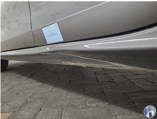
4. linkerszijde Deuk/deuken - Herstellen
