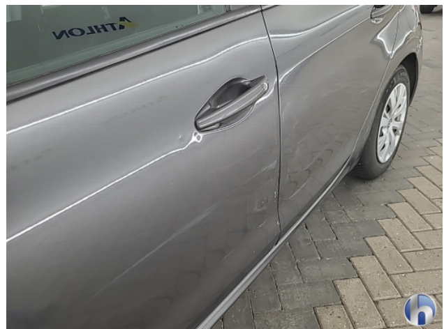
4. linkerzijde Deuk/deuken - Herstellen
