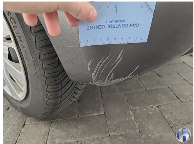
4. linkerzijde Deuk/deuken - Herstellen
