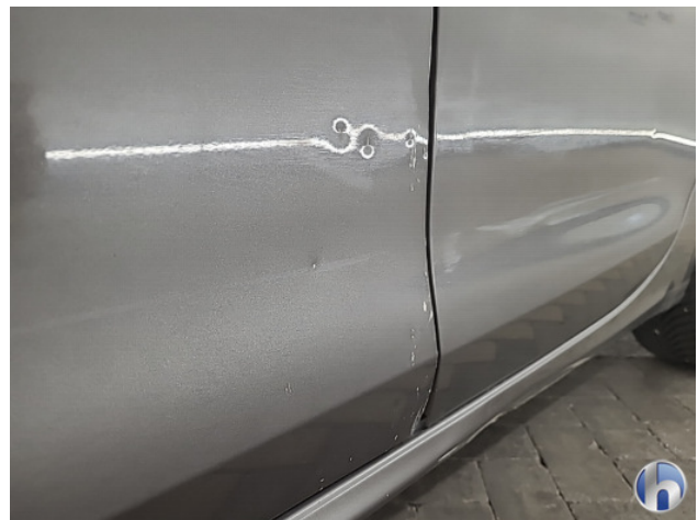
4. linkerszijde Deuk/deuken - Herstellen
