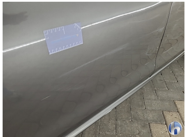
4. linkerzijde Deuk/deuken - Herstellen
