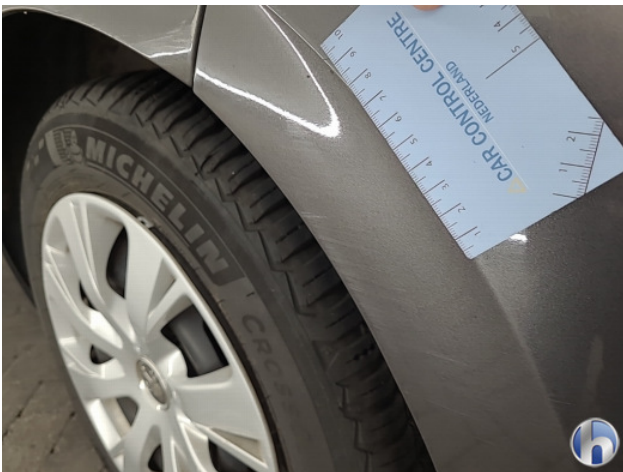
4. linkerzijde Deuk/deuken - Herstellen
