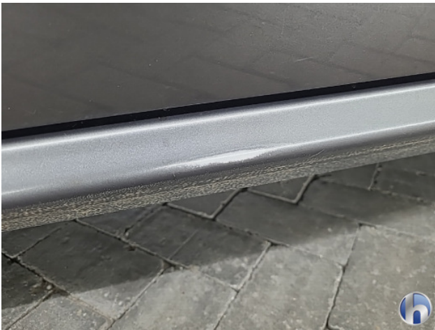
4. linkerszijde Deuk/deuken - Herstellen
