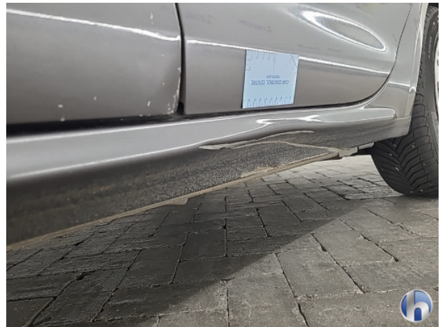
4. linkerszijde Deuk/deuken - Herstellen
