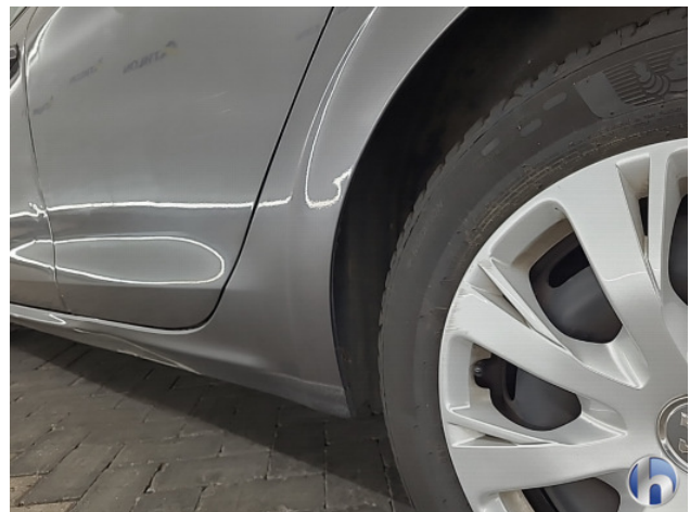
4. linkerzijde Deuk/deuken - Herstellen
