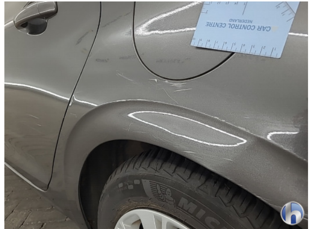
4. linkerzijde Deuk/deuken - Herstellen
