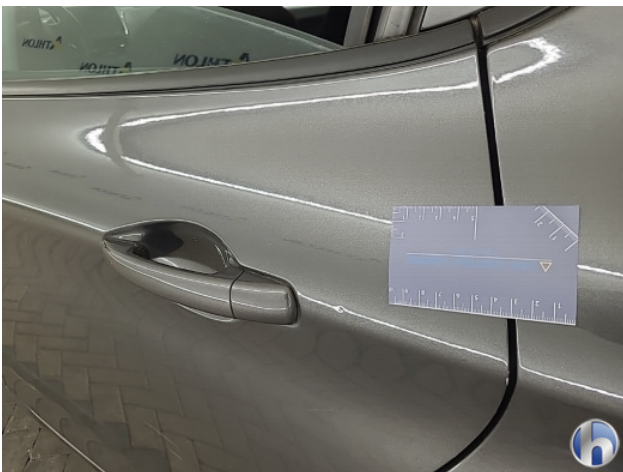
4. linkerzijde Deuk/deuken - Herstellen
