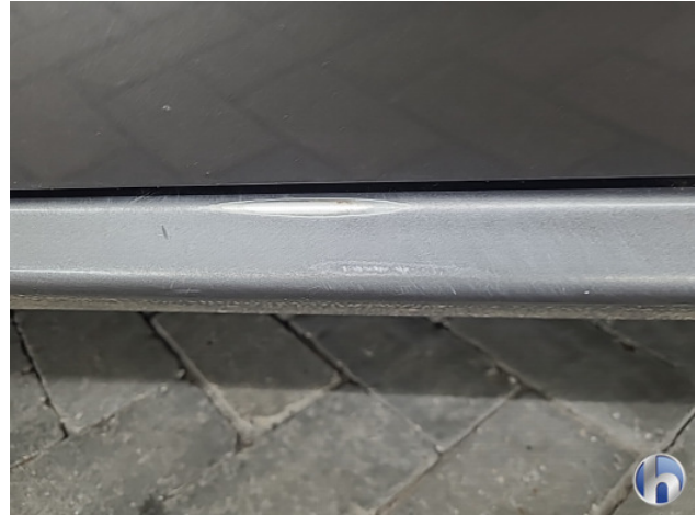
4. linkerszijde Deuk/deuken - Herstellen
