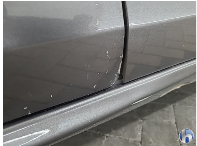
4. linkerszijde Deuk/deuken - Herstellen
