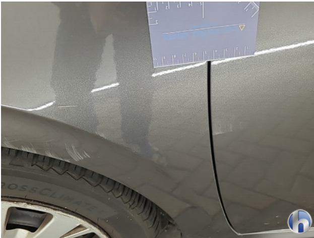
4. linkerzijde Deuk/deuken - Herstellen
