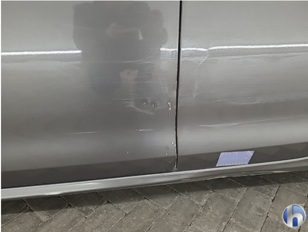
4. linkerzijde Deuk/deuken - Herstellen
