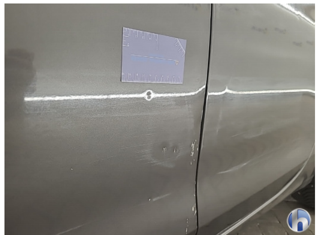
4. linkerszijde Deuk/deuken - Herstellen
