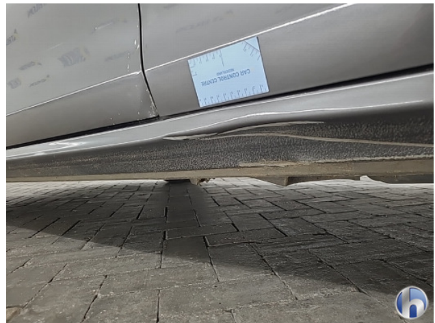
4. linkerszijde Deuk/deuken - Herstellen
