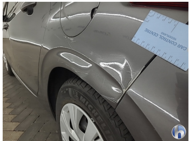
4. linkerzijde Deuk/deuken - Herstellen
