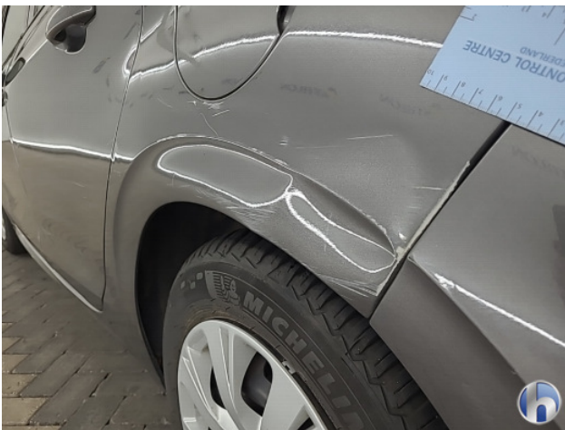
4. linkerzijde Deuk/deuken - Herstellen
