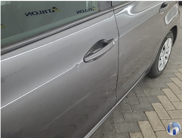
4. linkerszijde Deuk/deuken - Herstellen
