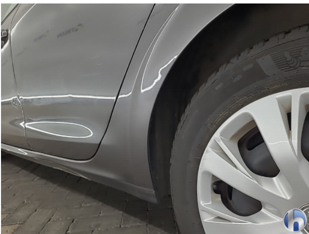
4. linkerzijde Deuk/deuken - Herstellen
