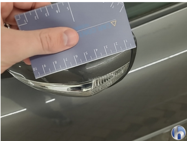
4. linkerzijde Deuk/deuken - Herstellen
