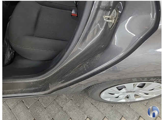
4. linkerzijde Deuk/deuken - Herstellen
