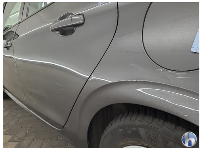
4. linkerzijde Deuk/deuken - Herstellen
