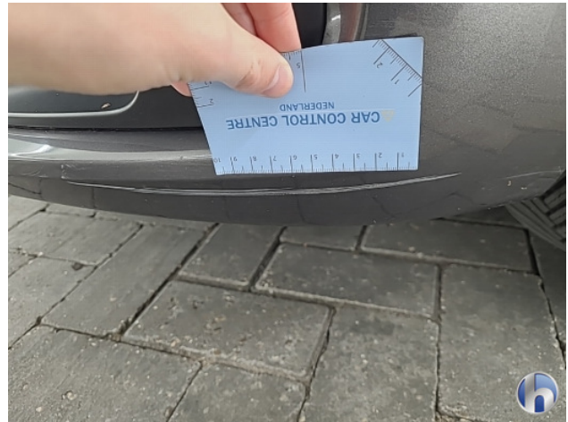
4. linkerzijde Deuk/deuken - Herstellen
