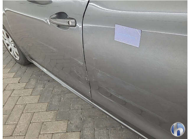
4. linkerzijde Deuk/deuken - Herstellen
