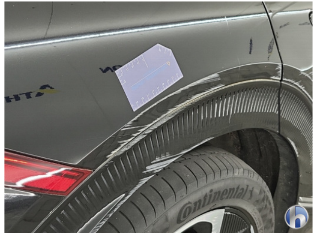
1. Zijwand - achter - rechts Schaafplek - Herstellen
