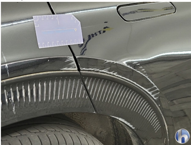
1. Zijwand - achter - rechts Schaafplek - Herstellen
