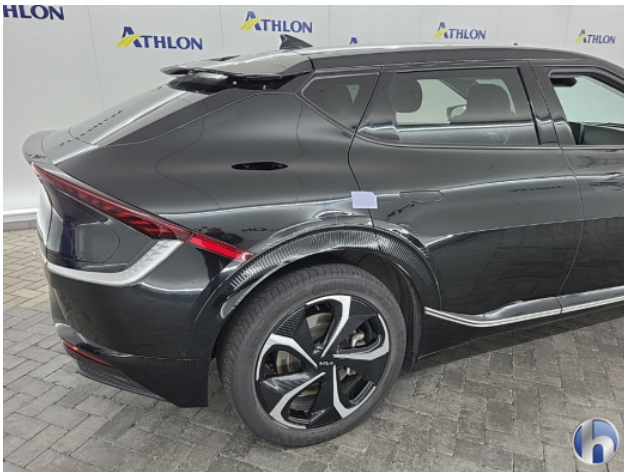
1. Zijwand - achter - rechts Schaafplek - Herstellen
