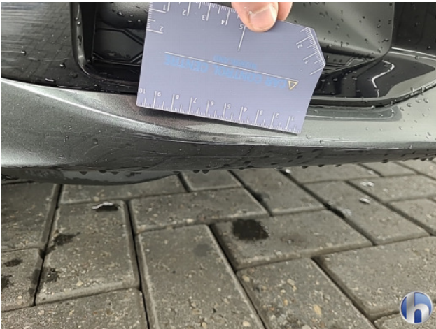
1. Diverse Gebruikssporen - Aanvaardbaar
