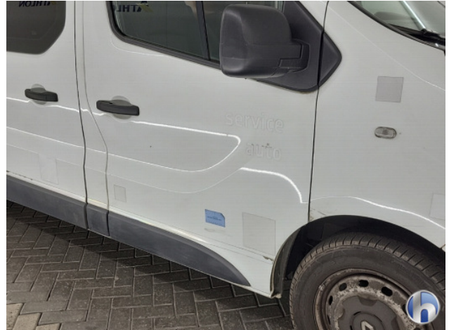
2. Portier voor - rechts Deuk/deuken - Herstellen
