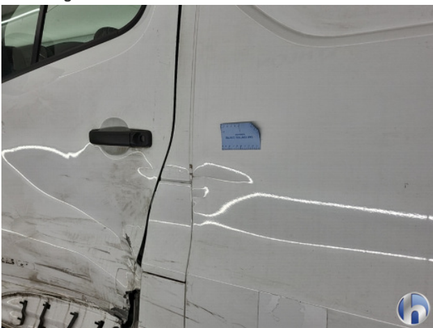
6. portier voor links Beschadigd - Vernieuwen
