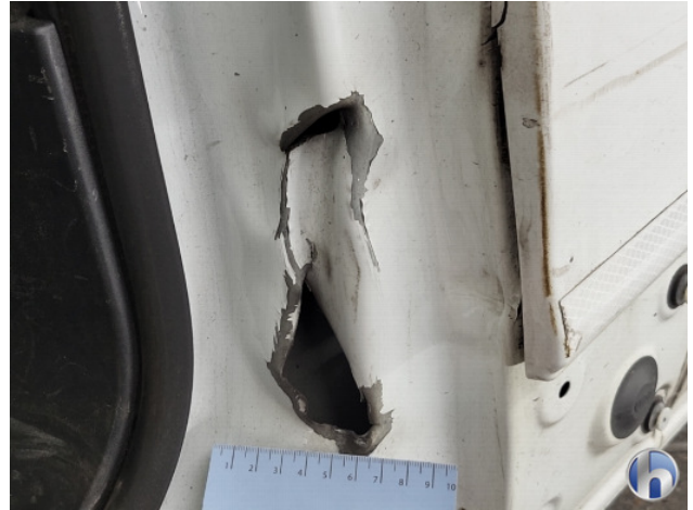
6. portier voor links Beschadigd - Vernieuwen
