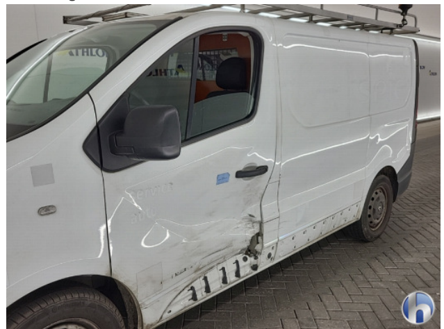
6. portier voor links Beschadigd - Vernieuwen
