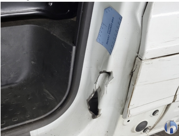
6. portier voor links Beschadigd - Vernieuwen
