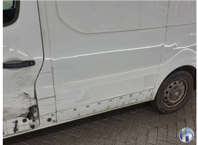
6. portier voor links Beschadigd - Vernieuwen
