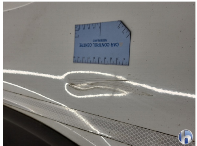
2. Portier voor - rechts Deuk/deuken - Herstellen
