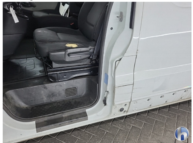
6. portier voor links Beschadigd - Vernieuwen
