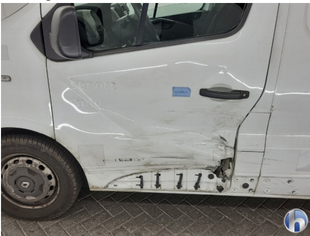
6. portier voor links Beschadigd - Vernieuwen
