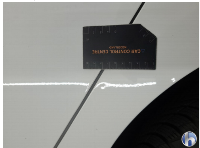
1. diverse schades Gebruikssporen - Aanvaardbaar
