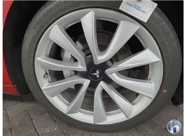
1. meerdere velgen Beschadigd - Herstellen
