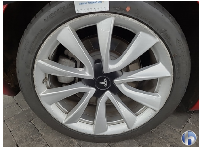
1. meerdere velgen Beschadigd - Herstellen
