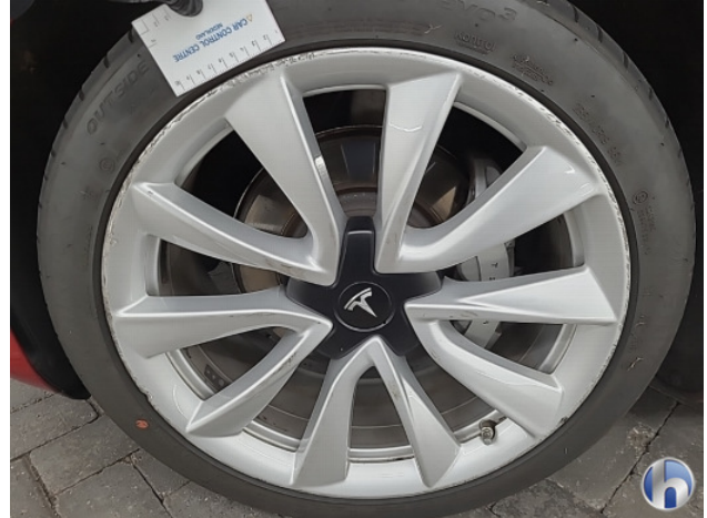
1. meerdere velgen Beschadigd - Herstellen
