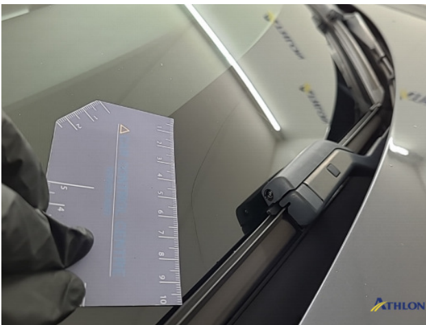
2. Voorruit Breuk / barst / scheur
