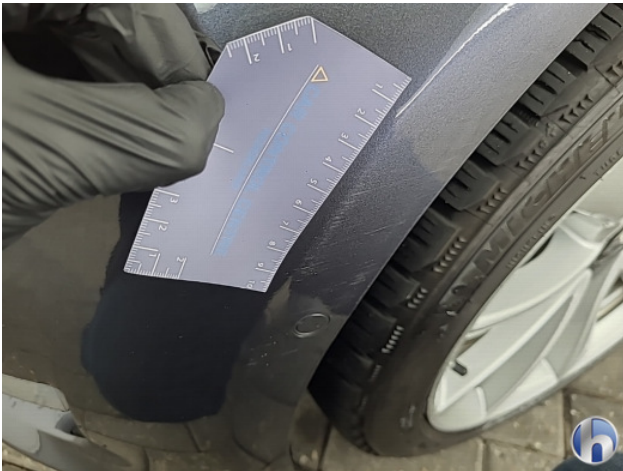
1. Voorbumper Schaafplek - Spot Repair/Deelreparatie
