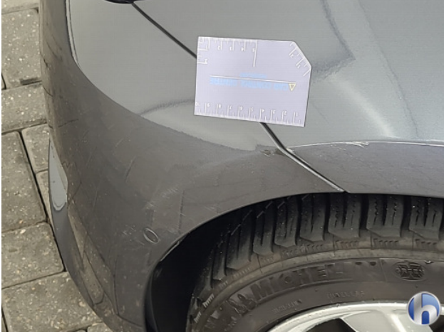
1. Voorbumper Schaafplek - Spot Repair/Deelreparatie
