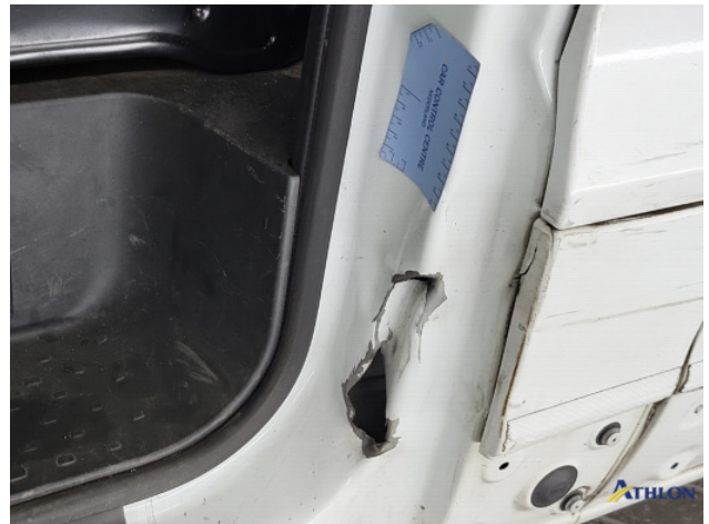
6. portier voor links Beschadigd
