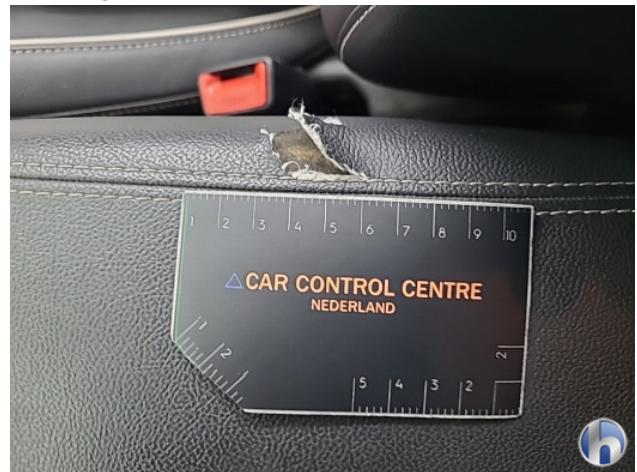
4. armsteun voor Beschadigd - Herstellen
