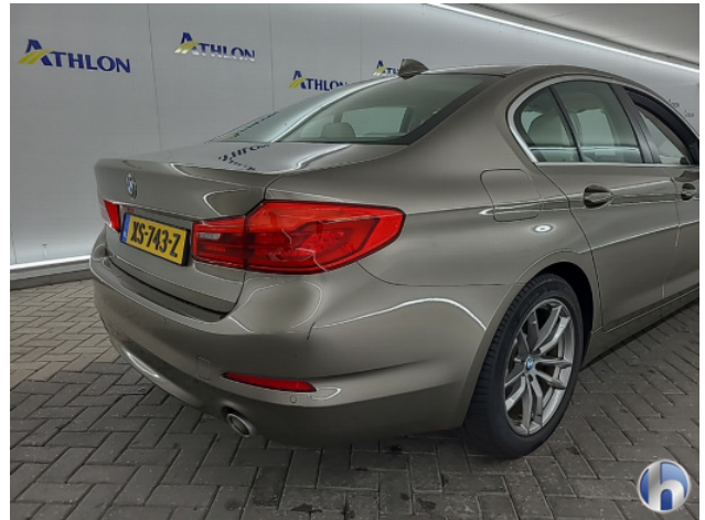
2. Achterbumper Krasen - Spot Repair/Deelreparatie
