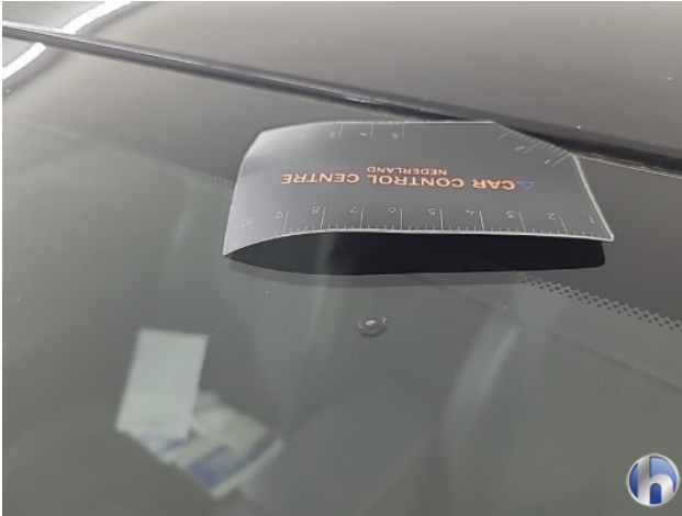
1. diverse schades Gebruikssporen - Aanvaardbaar
