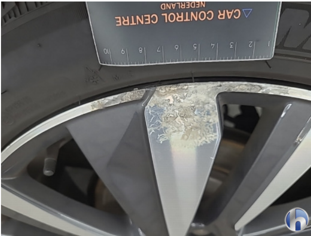
1. diverse schades Gebruikssporen - Aanvaardbaar
