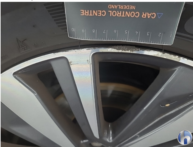
1. diverse schades Gebruikssporen - Aanvaardbaar
