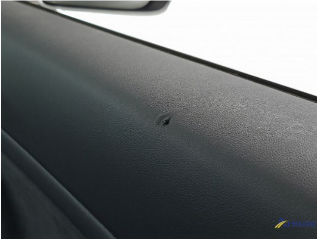
1. Deuropening voor - rechts Breuk / barst / scheur
