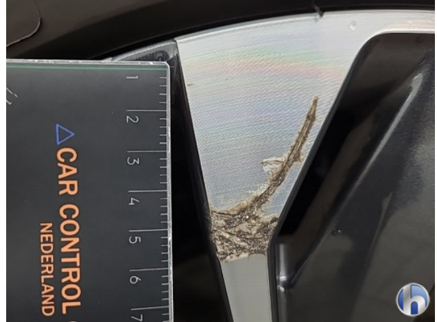
1. Diverse Gebruikssporen - Aanvaardbaar
