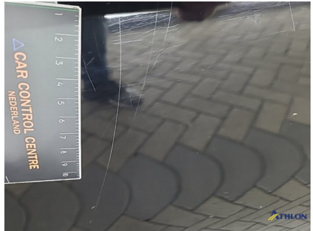
4. Portier achter - rechts Krassen
