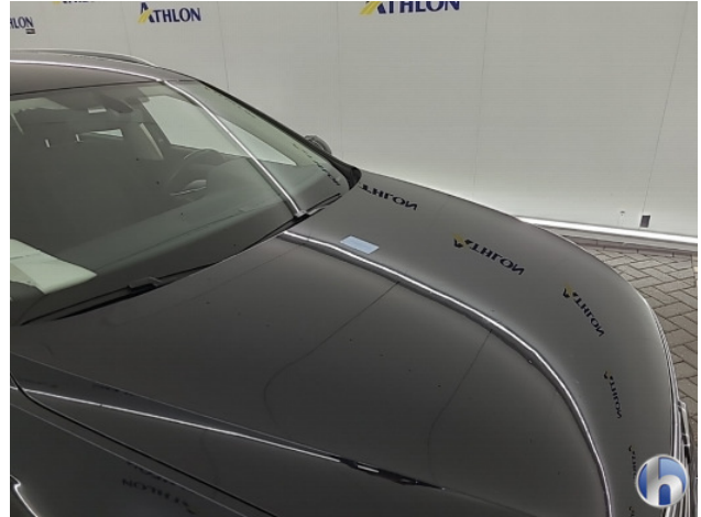
2. Motorkap Hagelschade - Herstellen zonder spuiten
