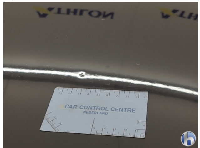
2. Motorkap Hagelschade - Herstellen zonder spuiten
