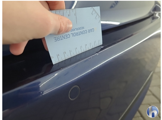
2. diverse Gebruikssporen - Aanvaardbaar
