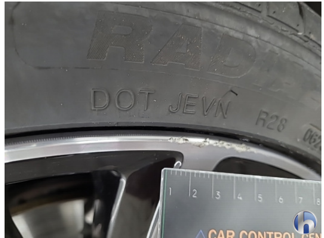
1. Diverse Gebruikssporen - Aanvaardbaar
