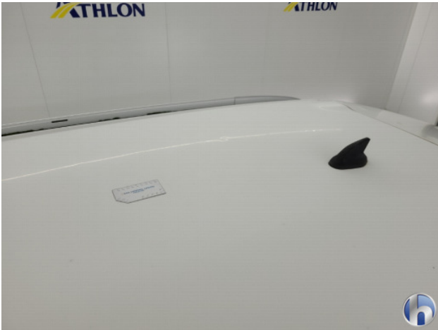
1. Dak Hagelschade - Herstellen zonder spuiten
