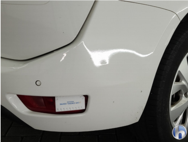
2. Achterbumper Deuk/deuken - Spot Repair/Deelreparatie
