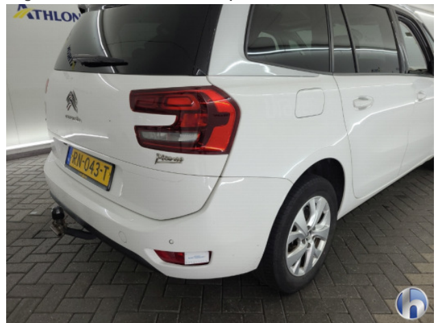
2. Achterbumper Deuk/deuken - Spot Repair/Deelreparatie
