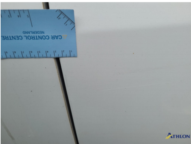
4. Zijwand - achter - rechts Deuk/deuken
