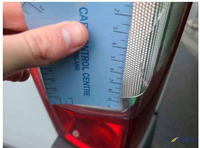
7. Achterlicht rechts Breuk / barst / scheur
