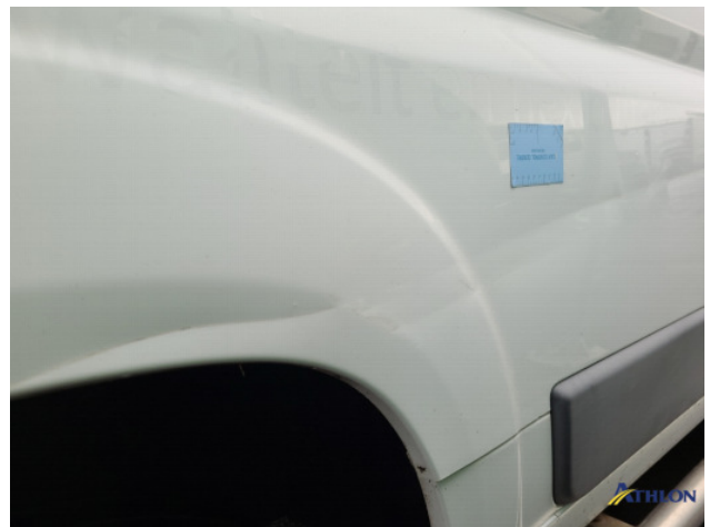
4. Zijwand - achter - rechts Deuk/deuken
