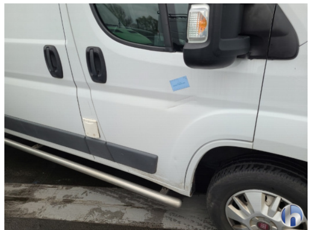
3. Portier voor - rechts Deuk/deuken - Herstellen
