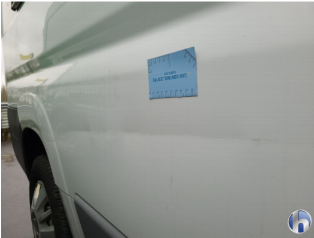
4. Zijwand - achter - rechts Deuk/deuken - Herstellen
