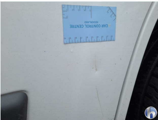
3. Portier voor - rechts Deuk/deuken - Herstellen
