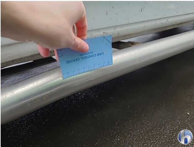
4. Zijwand - achter - rechts Deuk/deuken - Herstellen
