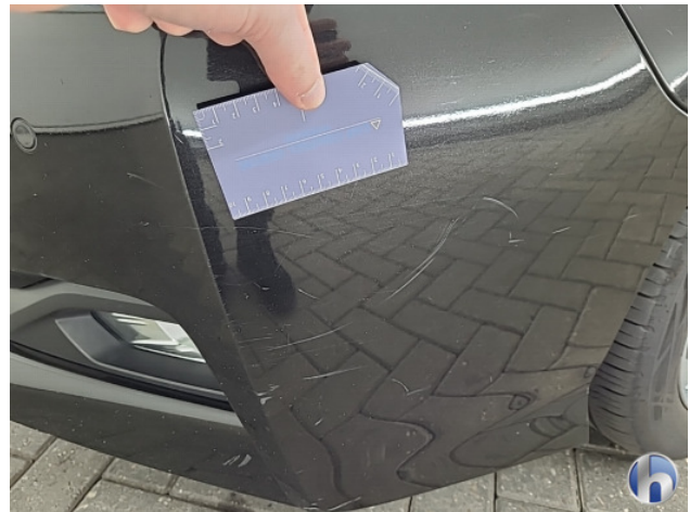
1. Diverse Gebruikssporen - Aanvaardbaar
