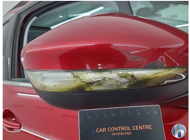
1. Spiegelbehuizing - rechts Breuk / barst / scheur - Vernieuwen
