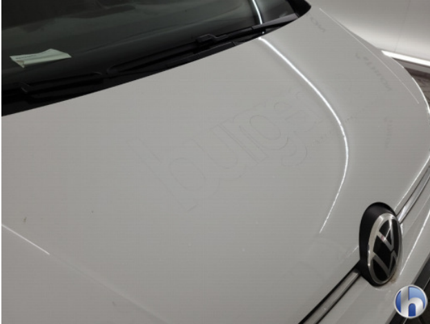
1. Ontstickerresten Gebruikssporen - Aanvaardbaar
