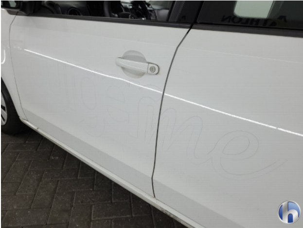
1. Ontstickerresten Gebruikssporen - Aanvaardbaar
