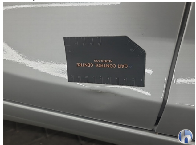
1. diverse schades Gebruikssporen - Aanvaardbaar
