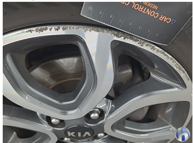
1. diverse schades Gebruikssporen - Aanvaardbaar
