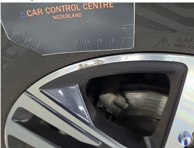
1. diverse schades Gebruikssporen - Aanvaardbaar
