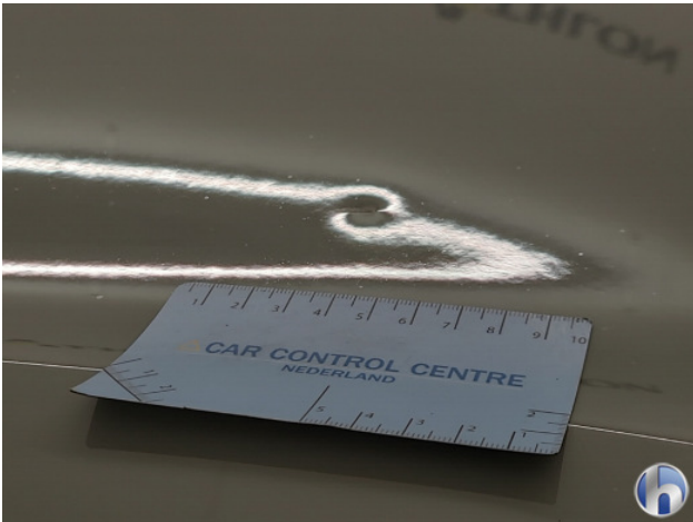
1. diverse Gebruikssporen - Aanvaardbaar
